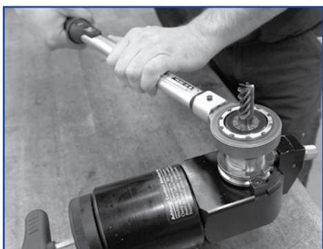
Diese Zeiten sind nun vorbei: Deutlich vermindertes Verletzungsrisiko mit dem FAHRION Rollenschlüssel
