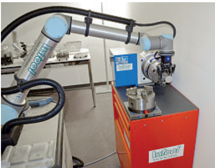
Mobil und hochflexibel: Die RoboCart-Lösung basiert auf einem kollaborierenden Roboter und benötigt keine Umhausung. (Bilder: TR)
